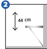
**2** Abaixee a haste e encoste na parede do fundo, posicionando o banco na altura que fique alinhado.
